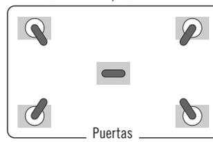
La disposición de 5 ruedas cuenta con ruedas de ataque que facilitan el movimiento sobre superficies irregulares y refuerzan el movimiento en línea recta.
